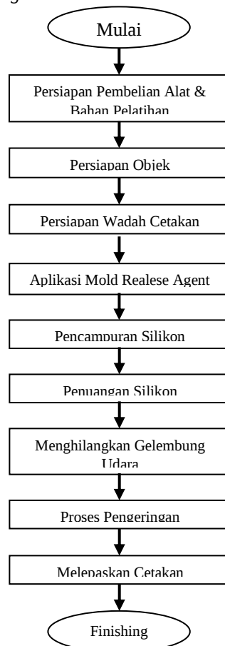
Gambar 1. Diagram alir tahapan pembuatan cetakan silikon food grade
