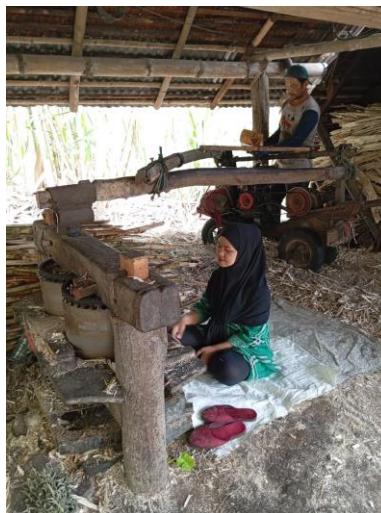
Gambar 4. Proses penggilingan tebu menggunakan mesin di pondok kilangan
